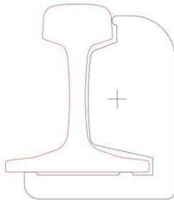
图 4.14 断面不对称正偏差合格测量示意
