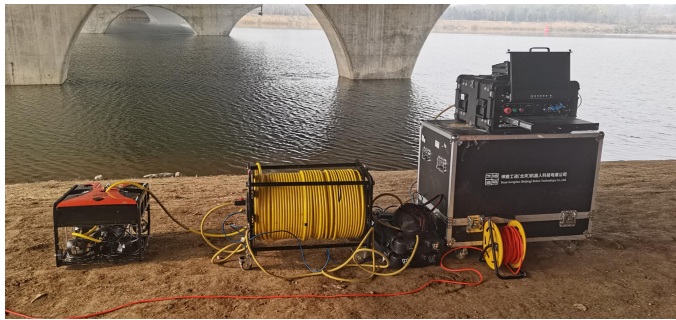
图 10 “海狮号”水下机器人测试系统
