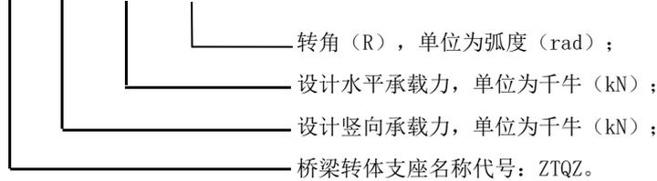
示例：设计竖向承载力为 25000kN，设计水平承载力为 1250kN，转角为 0.005rad 的桥梁转体支座，其型号表示为：ZTQZ-25000/1250/0.005。
