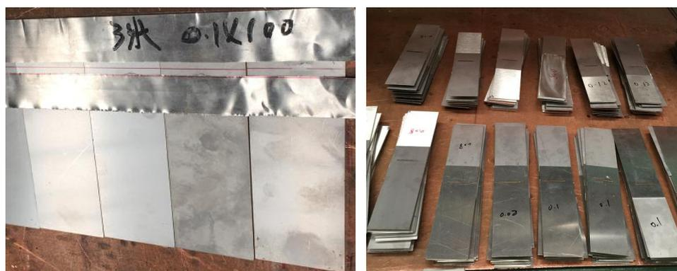
图 1 预制间隙及试验试板照片
