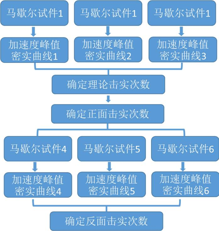
图 3 沥青混合料试件击实次数判定流程图
